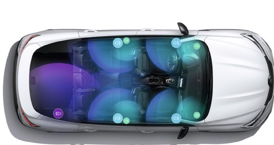
2 augstfrekvences skaļruņi paneļa sānos, 4 zemfrekvences skaļruņi priekšējo un aizmugurējo durvju paneļos, 2 augstfrekvences skaļruņi aizmugurējo durvju paneļos un 1 zemfrekvences skaļrunis bagāžniekā.
