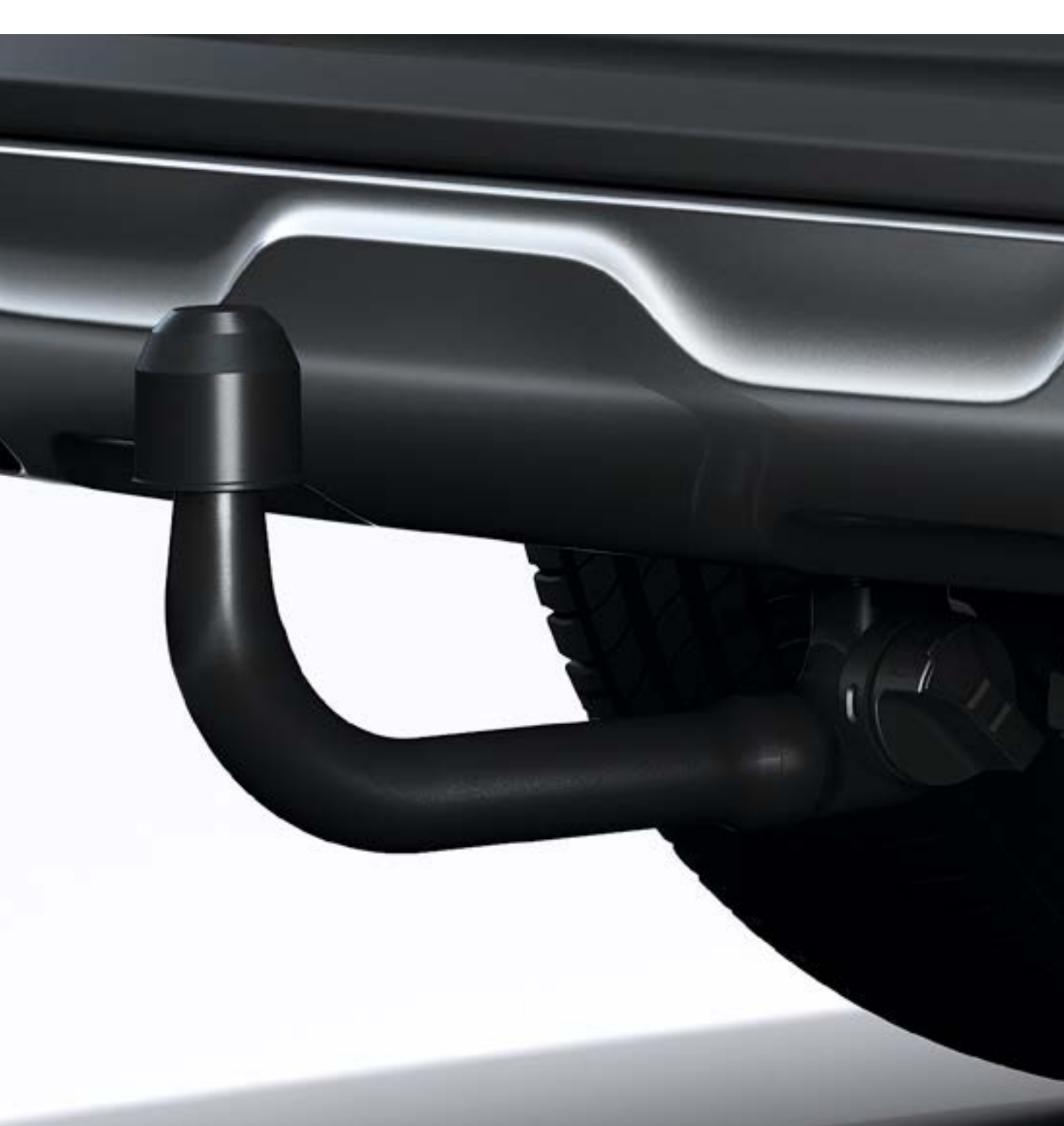
Sakabes āķis noņemams bez instrumentiem
