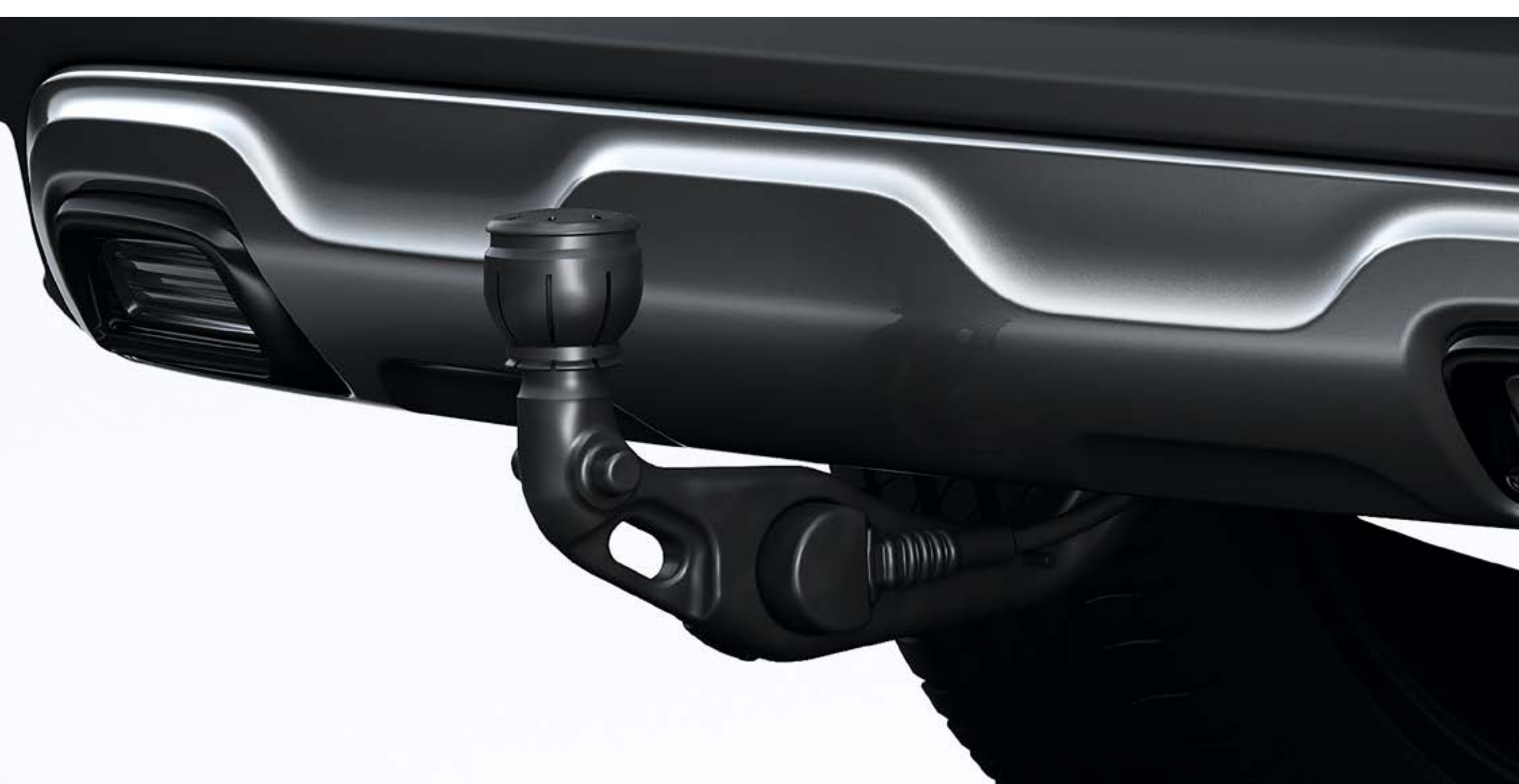
Izvelkams, pusautomātisks sakabes āķis
