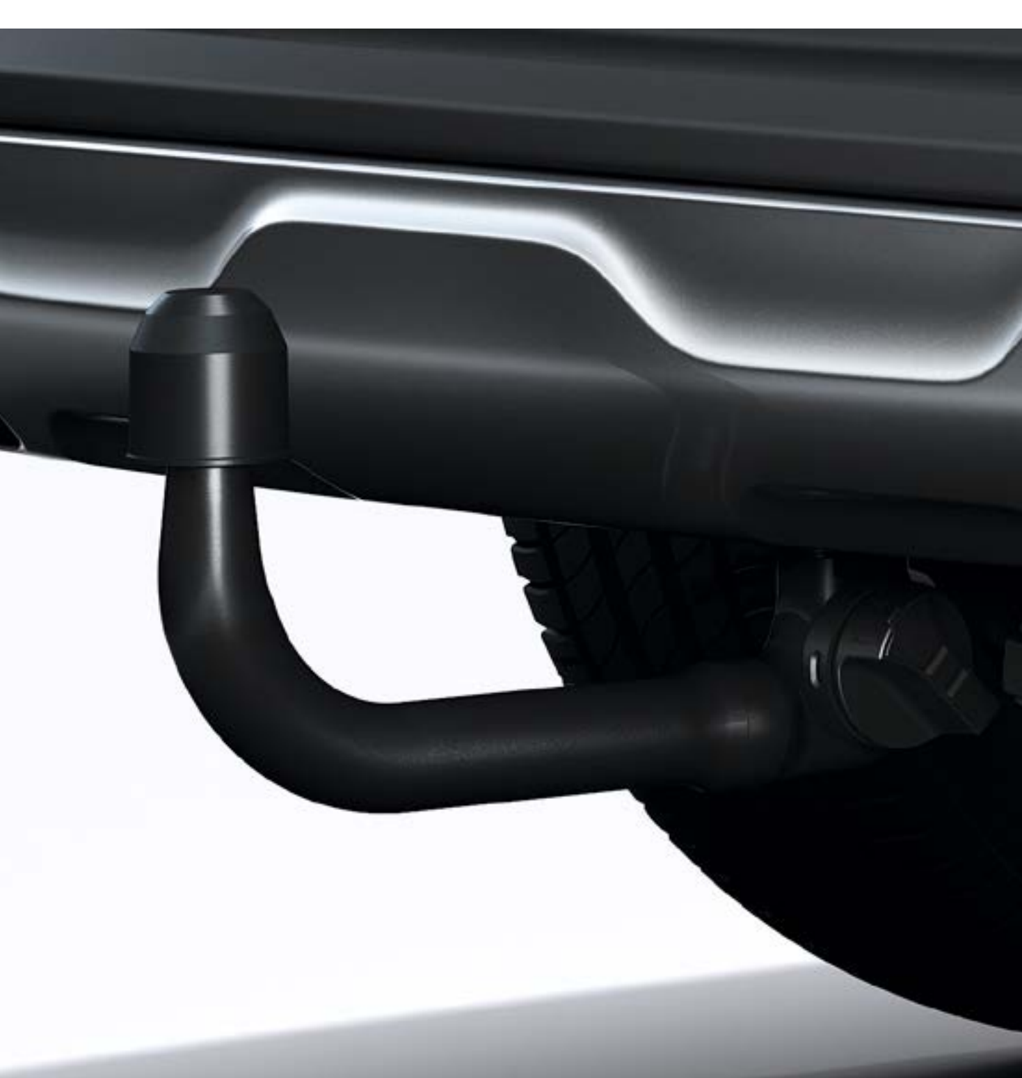
Sakabes āķis noņemams bez instrumentiem
