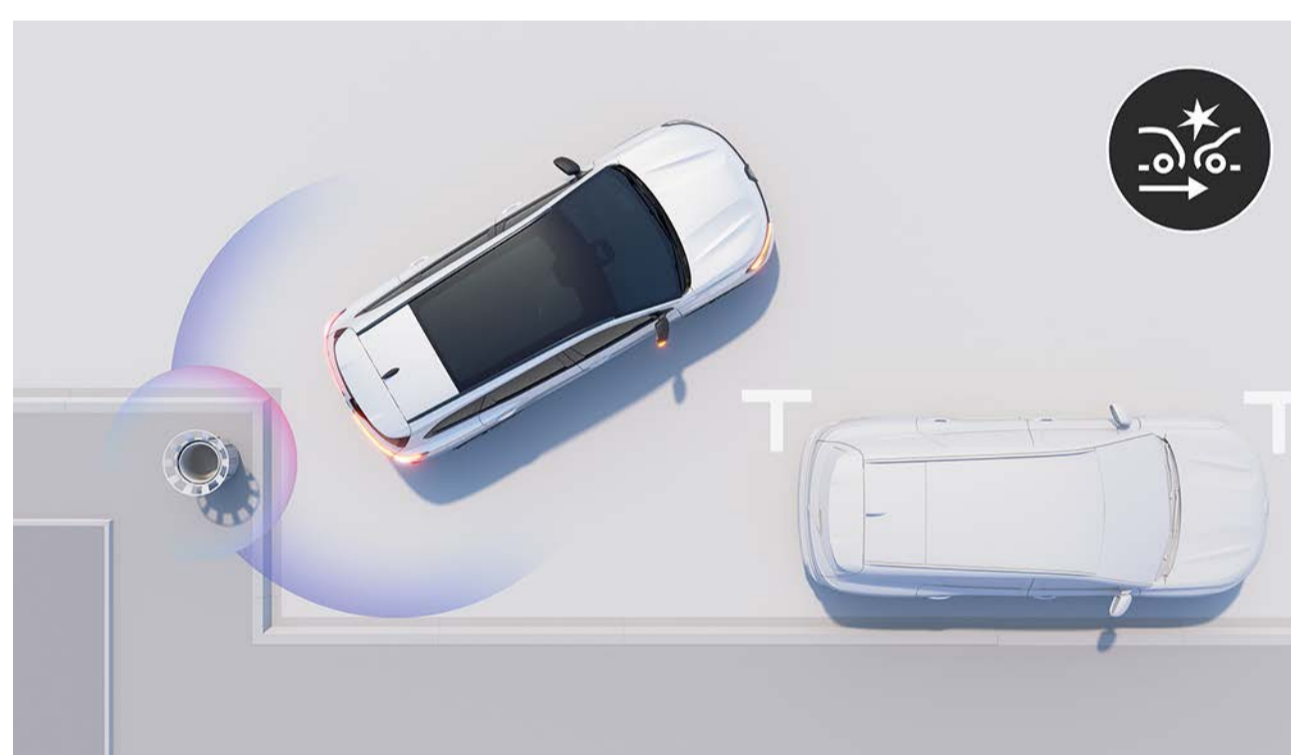
aizmugurējā automātiskā avārijas bremsēšana (R-AEB)
